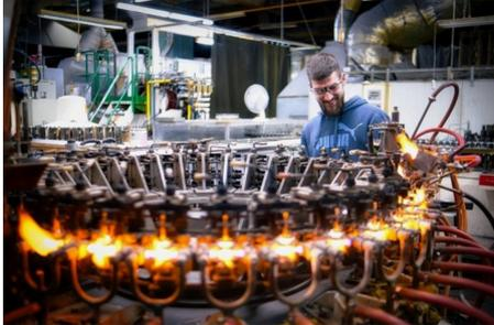
Sören Bollmann ist einer von 135 Beschäftigten bei der Narva Lichtquellen GmbH & Co. KG in Brand-Erbisdorf. Das Foto zeigt, wie er an der Gestellfertigung für die Lampenproduktion arbeitet. Foto: Nico Rinno/Narva
